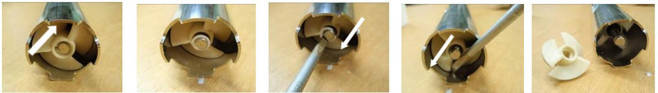
**DL-R:** Schrauben Sie den Pumpenfuß ab. **Linksgewinde!** Mit Hilfe eines Schraubendrehers können Sie den Rastring von der Welle entfernen. Ziehen Sie das Laufrad von der Welle ab (Benutzen Sie ein Hilfsmittel). Schrauben Sie den 1. Stufenring ab. **Linksgewinde!** Rastring entfernen, 2. Laufrad von der Welle abziehen. 2. Stufenring wie 1. Stufenring lösen.
