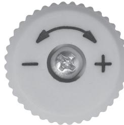
Bei lösungsmittelfreiem (wasserlöslichem) Tiefgrund ist grundsätzlich das Druckregulierventil um ca. 1,5 Umdrehungen in Richtung **-** herauszudrehen.
